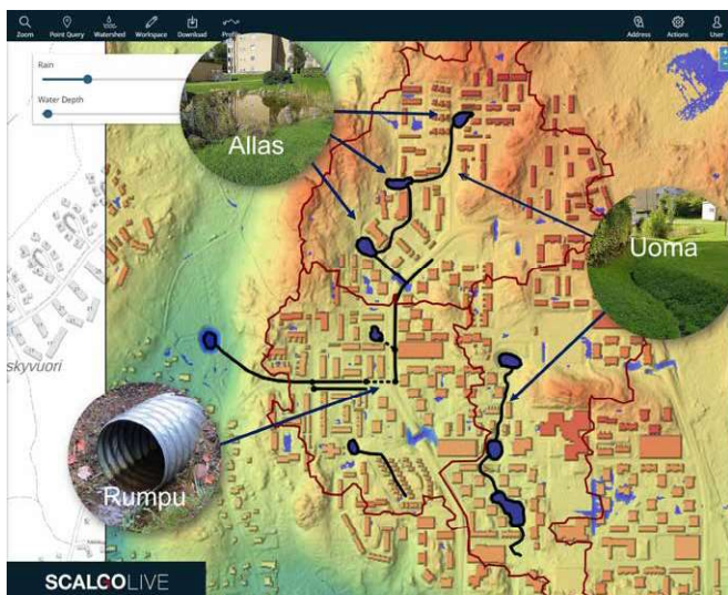
Kuva 5. Varissuon valuma-alueella on pitkälti hyödynnetty olemassa olevia virtausreitit, joihin on lisätty altaita tulvavesien varastointiin ja viivyttämiseen.
